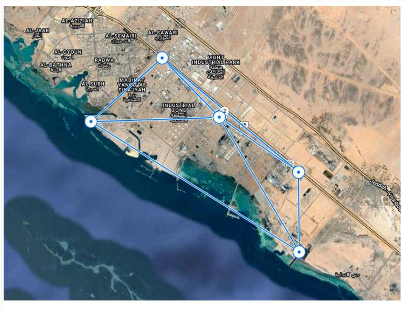
Cuatro backhaul punto a punto que operan a 60 GHz con respaldo automático en 5 GHz para prevenir fuertes lluvias. Conectan la TORRE PRINCIPAL con las torres A, B, C y D. Otros cuatro backhaul punto a punto que operan a 5 GHz previenen fallos de hardware conectando A con B, B con C, C con D y D con A.
