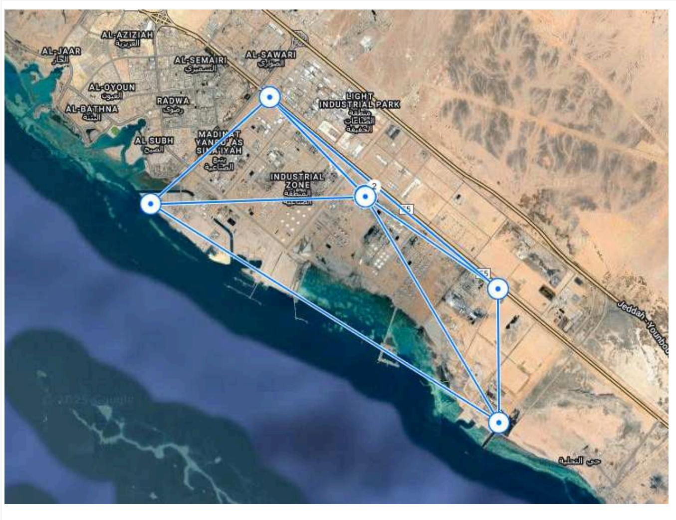
Quattro collegamenti backhaul punto-punto operanti a 60 GHz con backup automatico a 5 GHz per prevenire danni causati da forti piogge. Collegano la TORRE PRINCIPALE alle torri A, B, C e D. Altri quattro collegamenti backhaul punto-punto operanti a 5 GHz prevengono guasti hardware collegando A a B, B a C, C a D e D ad A.
